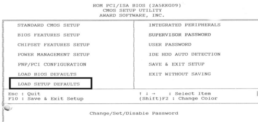
**LOAD SETUP DEFAULTS:** Mit dem Cursor auf diesen Menüpunkt wechseln und mit "Enter" und "Y" diese laden.
